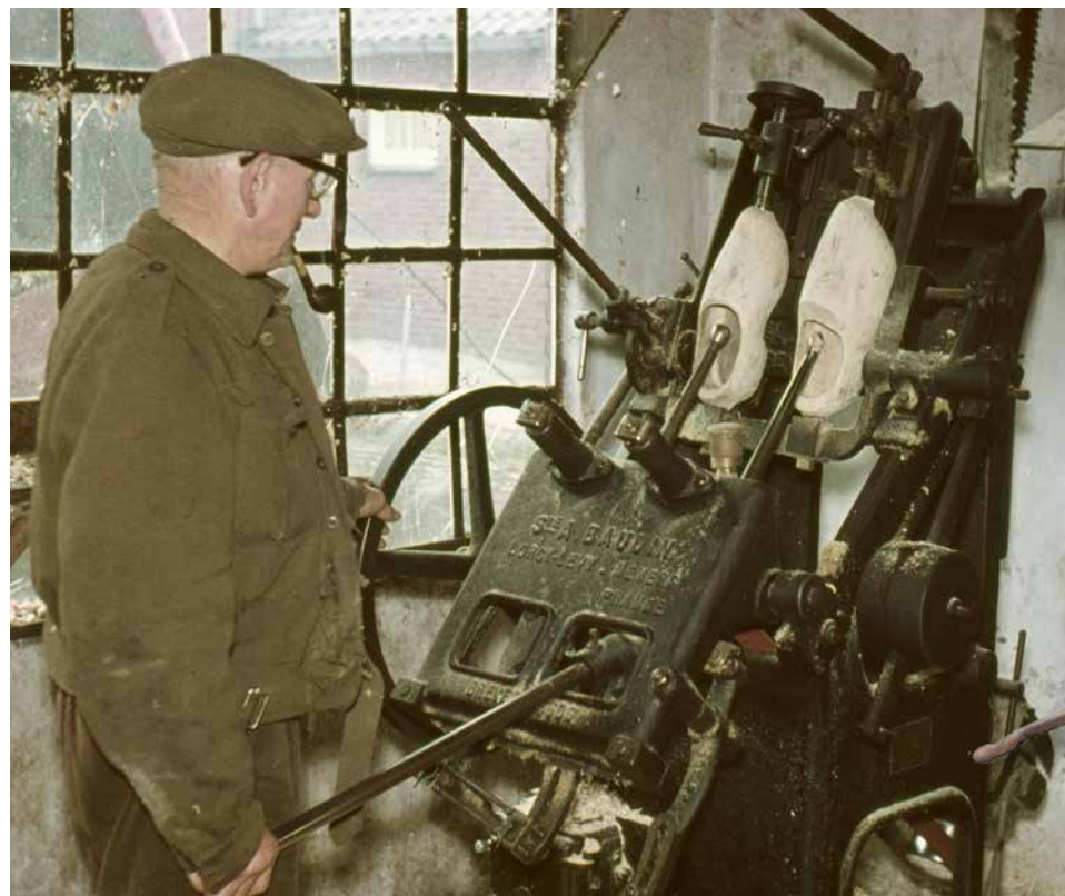
Als laatste bewerking werden de klompenbroodjes op een freesmachine, met een snel ronddraaiende beitel, uitgehold. (Foto: familiearchief Van Bree)
